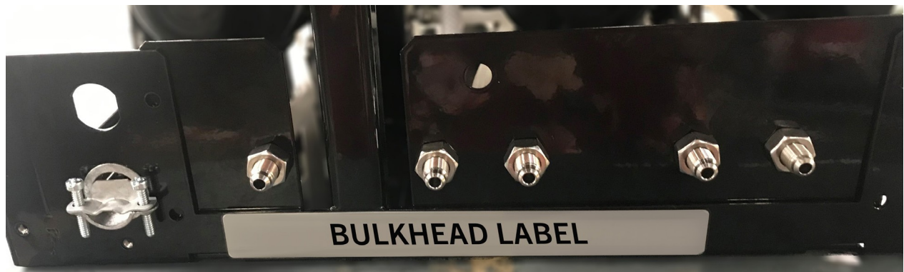
Figura 4.3 Ubicación de la etiqueta de acople de los accesorios del panel separador
