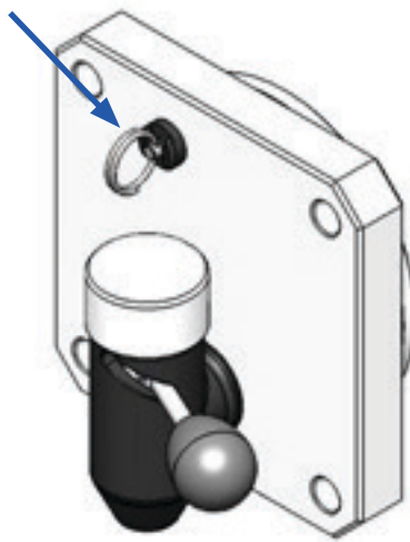
Figure 5.3 Emplacement de la soupape de décharge sur différents types de plastrons
